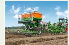
Pnomatik direkt ekim makinesi Primera DMC
