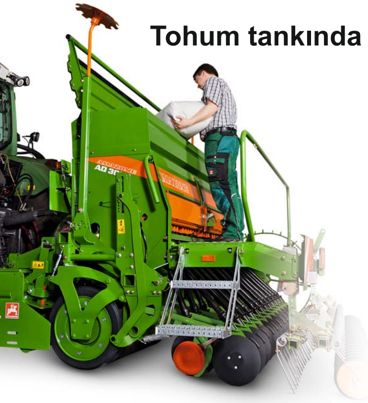
Tohum yükleme yardımcısı, tohum tankı çuval aracılığı ile doldurulurken büyük kolaylık sağlar.
