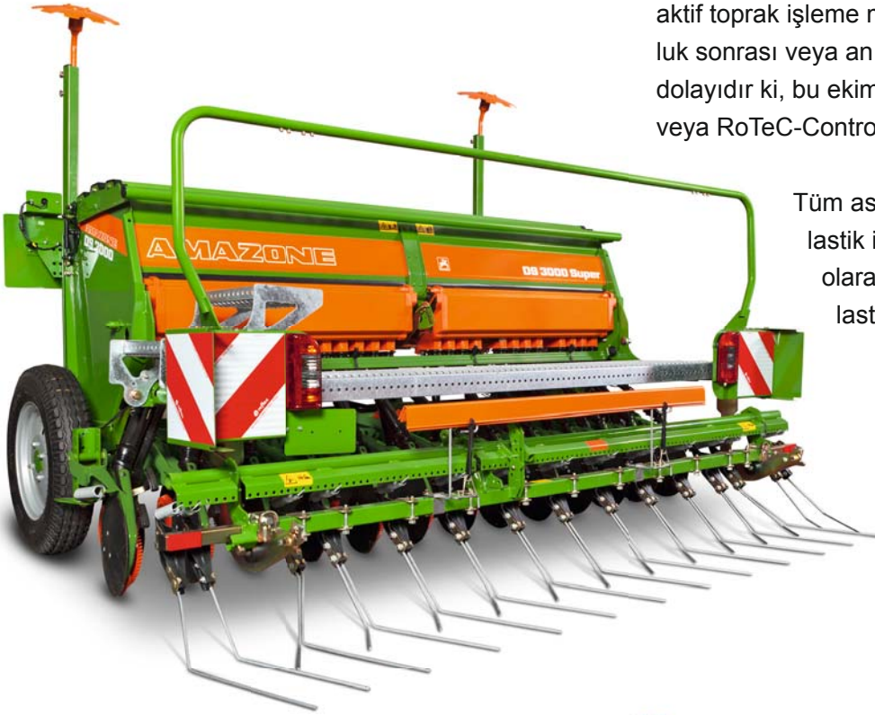
3 m çalışma genişliği ve RoTeC-Control ekim ayaklı D9 3000 Super. (Resimdeki yan uyarı levhaları Fransa'ya özeldir)
