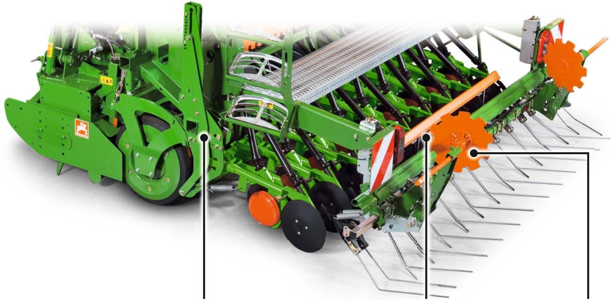
Ekim ayağı baskısının hidrolik olarak ayarlanması
