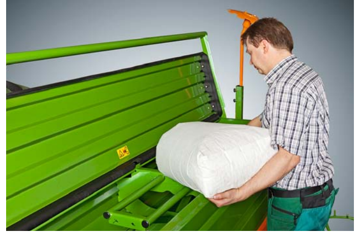
Tohum yükleme yardımcısı, tohum tankı çuval aracılığı ile doldurulurken büyük kolaylık sağlar.
