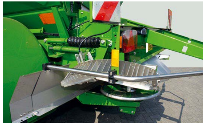
Normal gübreleme için Limiter (sınırlandırıcı) yukarı katlanmış pozisyonda
