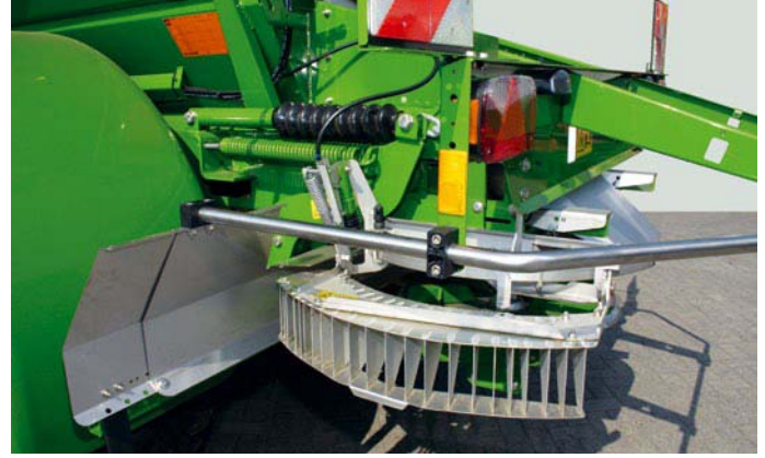
Limiter (sınırlandırıcı) çalışma pozisyonunda
