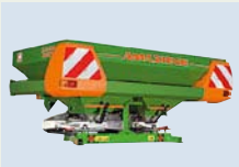
İki diskli gübre serpmesi makinesi ZA-M 1000–3000 litre, 10–36 m
