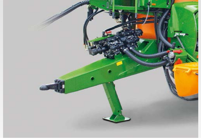
Hidrolik pompa ile tahrik edilen ve sabit olan alt çeki Hitch
