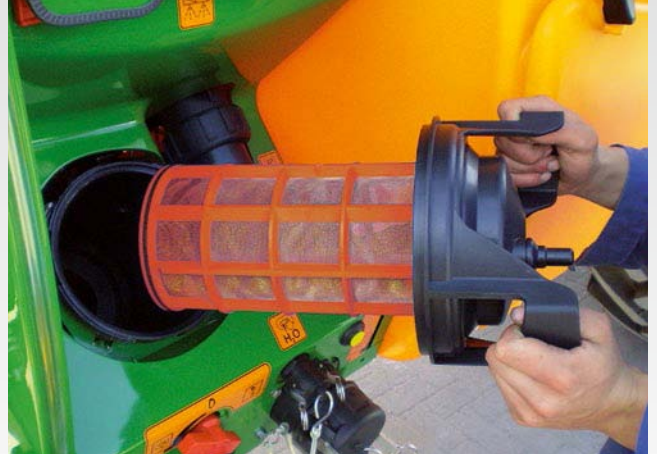
Emiş filtresi tank dolu iken, herhangi bir sıvı dışarı akmadan açılabilir.
