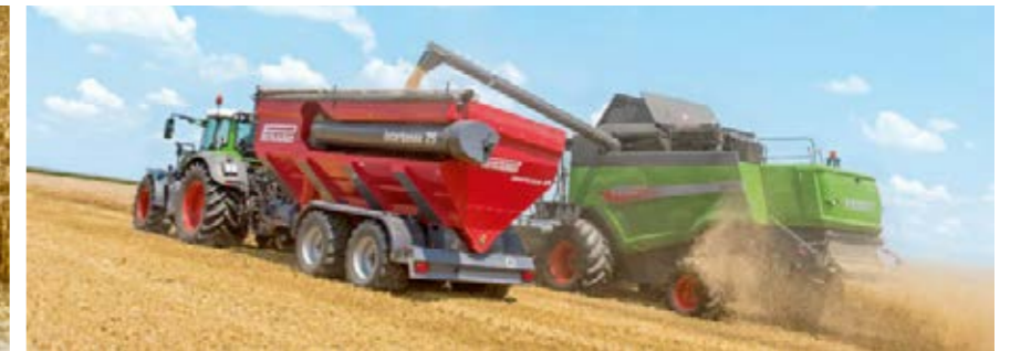
Bölmelere ayrılmış yapıdaki kontrbatörde bulunan dar yapıdaki 14 mm tel aralıkları sayesinde tahıl hasadında kusursuz harmanlama sonuçları elde edilir.
